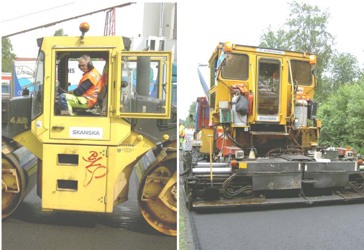
Bild 37: Det ser påfallande möjligt ut att trampa fel i en inte särskilt förlåtande omgivning. Konstruktörerna skulle kanske arbeta i sina skapelser en säsong.
