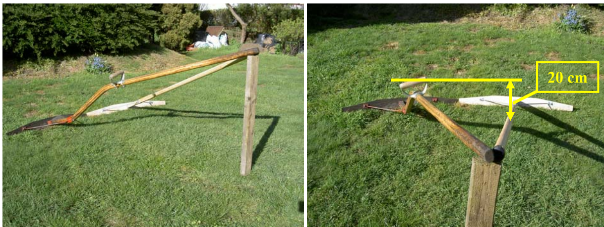
Bild 30: Ett monterat s.k. slunggrepp ger asfaltrakan bättre styrsel med mindre kraftansträngning och rätar ytterligare upp arbetsställningen.
