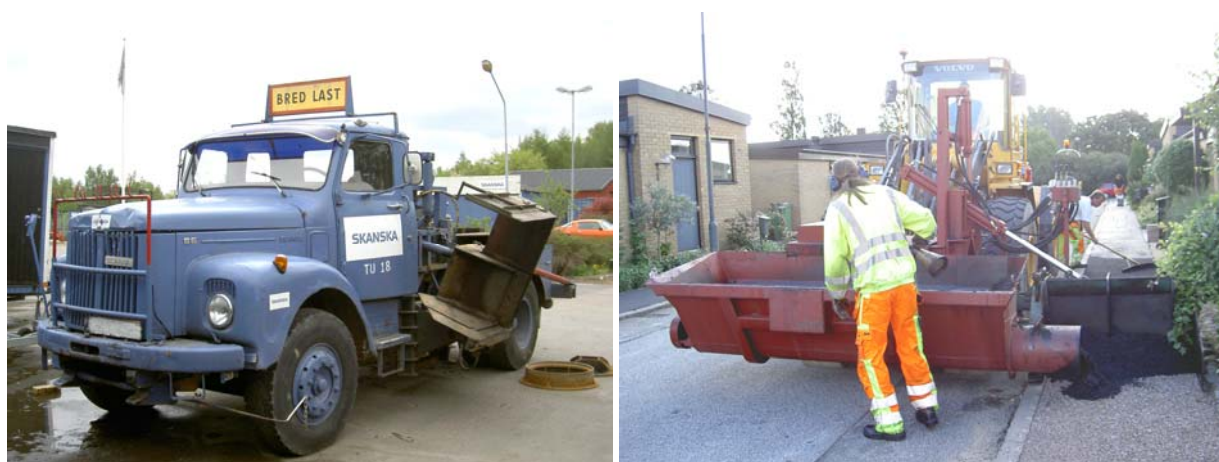
Bild 25: En uppskattad men dessvärre utrangerad avjämningsmaskin för trottoarläggning (t. v.) och traktormonterad prototyp med liknande funktion (under utveckling).
