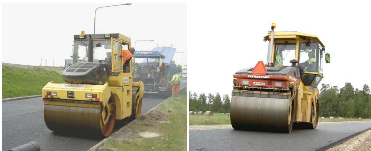
Bild 20: Behovet av vältförarens ständiga vridningar och sidolutningar av kroppen kommer av en fixerad förarposition och dålig sikt. Halvvägs vridning och placering på ena sidan avhjälper en hel del av problemet.
