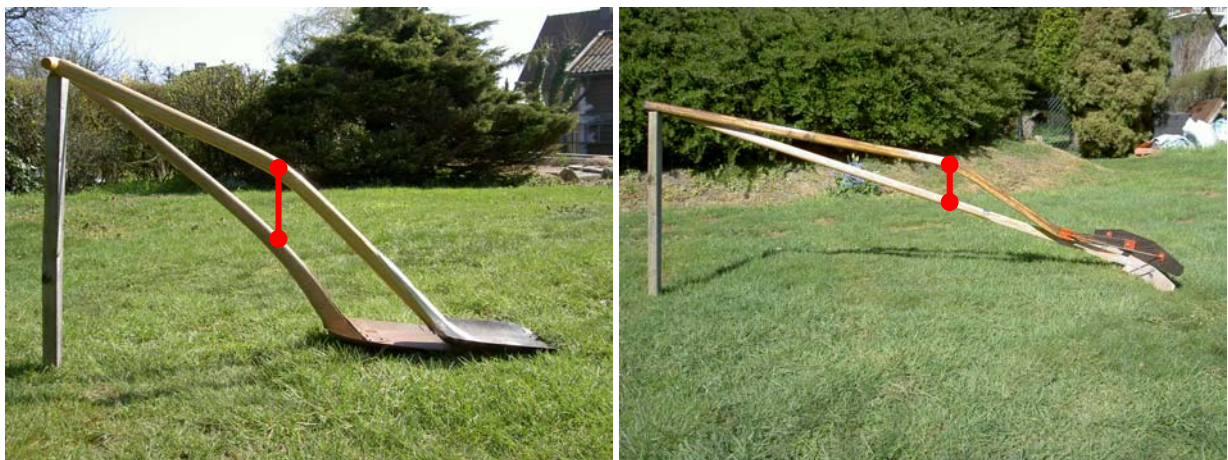
Bild 29: Ergonomiskt utformade asfaltredskap jämförda med konventionella modeller.
